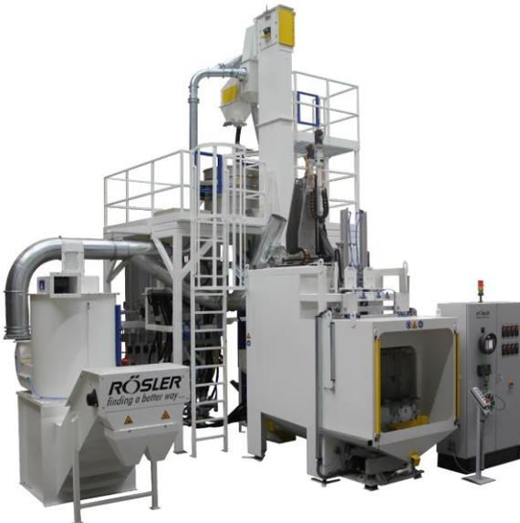
La cabina de granallado de la granalladora con mesa giratoria RWT 13/4 S es especialmente resistente al desgaste y accesible para fines de mantenimiento.
